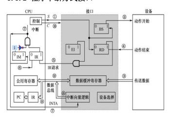
程序中断方式基本接口如图所示,程序控制由外设接口的状态和 CPU 两方面来控制。在接口方面,有决定是否向 CPU 发出中断请求的机构,主要是接中中的"准备就绪"标志(RD)和"允许中断"标志(EI)两个触发器。在 CPU 方面,有决定是否受理中断请求的机构,主要是"中断请求"标志(IR)和"中断屏蔽"标志(IM)两个触发器。
