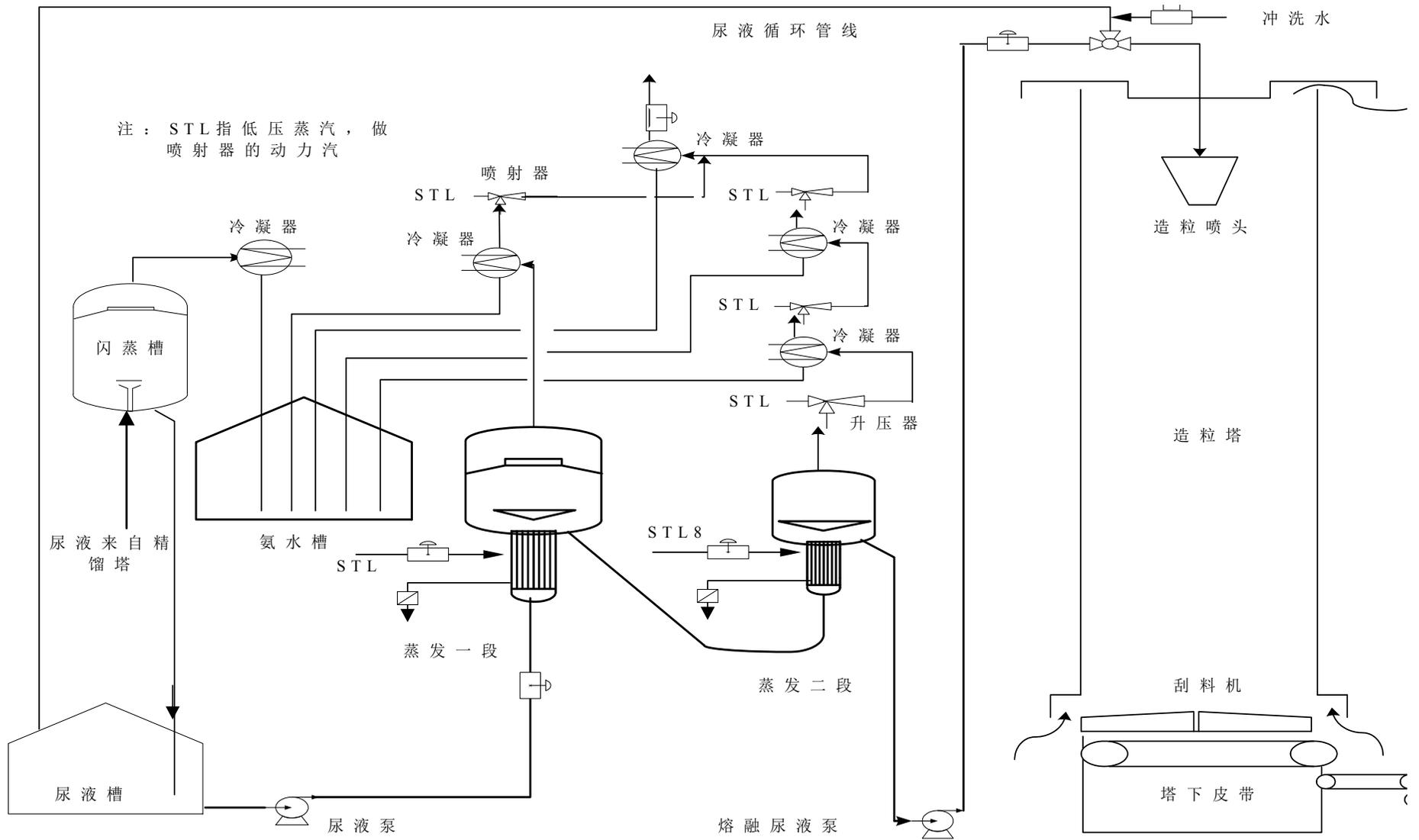
图 3-6 尿液的真空蒸发与造粒流程
